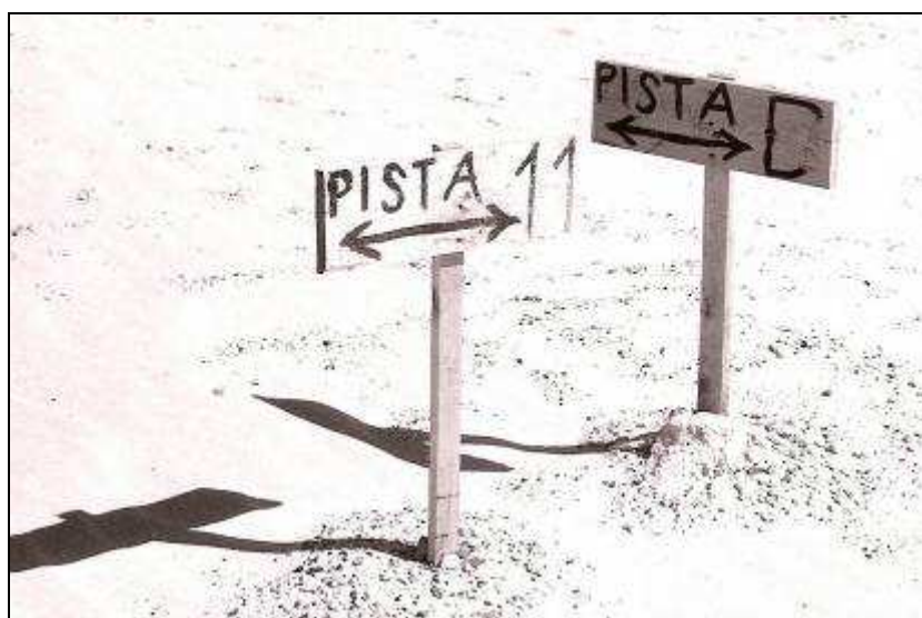
Fig. 28 - Rete gravimetrica Lerici : incrocio Linea O-E (lettera) con linea N-S (numero)
