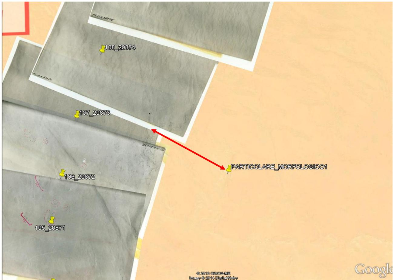
In figura si mostra una serie di fotogrammi che mostrano un territorio fortemente deformato dalla prospettiva lungo il bordo destro: in tal modo risulta impossibile posizionare correttamente i fotogrammi in modo che “ricoprano” perfettamente il paesaggio; nel caso specifico è stato riconosciuto un particolare morfologico (un piccolo altopiano eroso) spostato di oltre 1,6 km verso oriente nella realtà rispetto alla posizione nel fotogramma.
