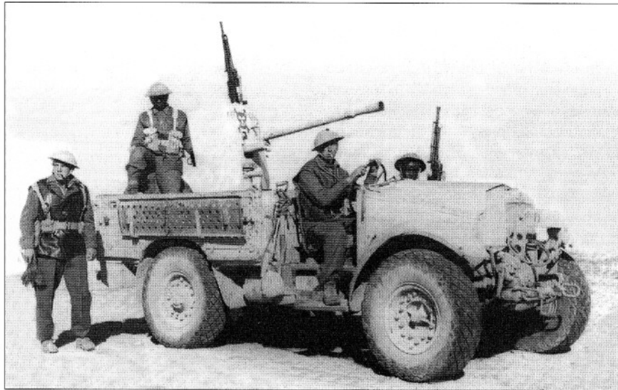
▲ Un Morris Commercial dit « Derviche » appartenant aux FFL ; son canon de 25mm modèle 1934 monté sur pivot peut tourner sur lui-même comme un Derviche ! Au Moyen-Orient, un Derviche désigne le membre d'une confrérie mystique musulmane dont la tradition veut que les prières soient récitées en tournant sur soi-même, ce de plus en plus rapidement Musée de l'Ordre de la Libération
