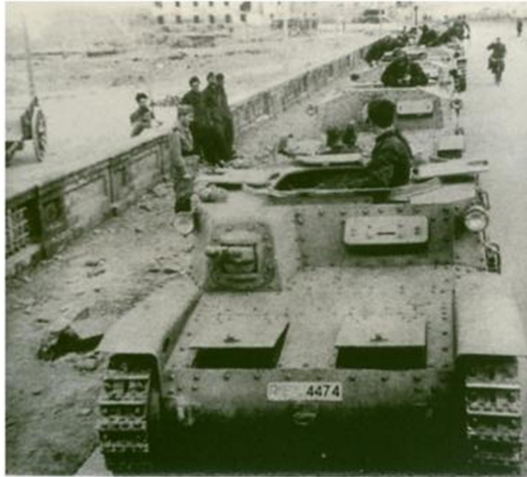
foto 6: Carro comando M40 per batterie semoventi, appena sbarcato a Tripoli nel dicembre 1941. Subito dietro di esso si notano i carri pezzo. Le sole mitragliatrici Breda 38 erano le armi di difesa del mezzo, ben poca cosa anche nei confronti di scontri con autoblinde avversarie.
